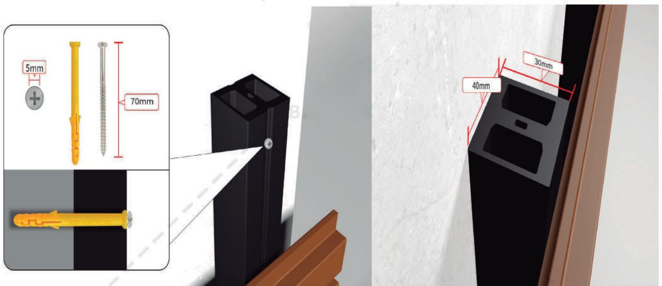
Los rastreles (de madera, acero galvanizado o aluminio) (se fijan con tornillos de expansión, que se introducen en la pared unos 50 mm (deduciendo el grosor de los rastreles).
